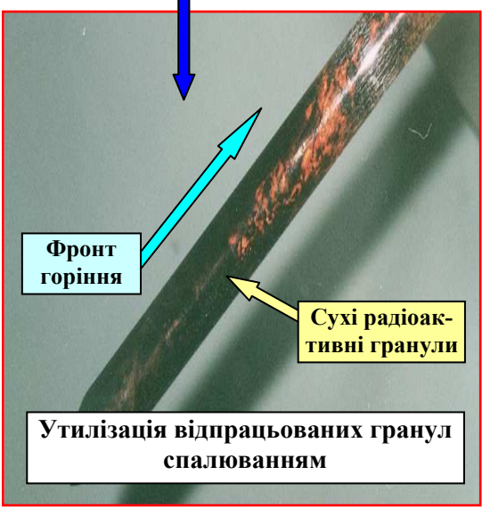
При спалюванні об'єм гранул зменшується у 3 рази, а Cr(OH) 3 · nH 2 O перетворюється в технічний абразив (кристалічний Cr 2 O 3 )
