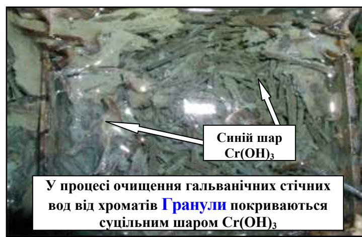
Установка для очищення стічних вод від хроматів та інших металів (завод «Коммаш», Київ)
